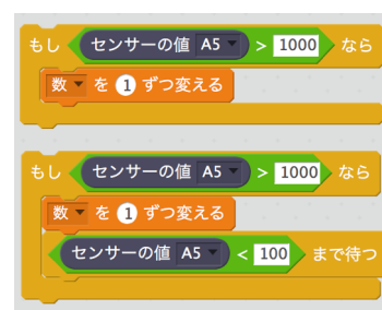
図 18 脈拍の数を数えるプログラム Fig.18 Program code to count the number of heart beats
