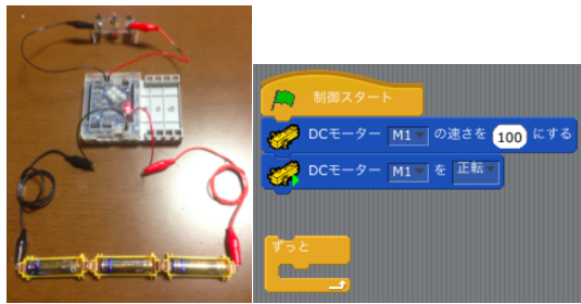
図6 豆電球の明るさを変えるプログラム Fig.6 Program to change brightness of small light bulb
