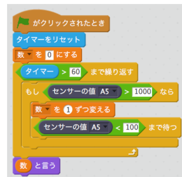
図2 脈拍数を表示するプログラム Fig.2 Program code to display heart rate
