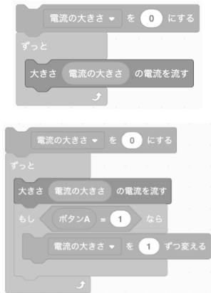
図2 電流の働きで作成するプログラムコード例
