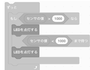
図3 天気の変化で作成するプログラムコード例
